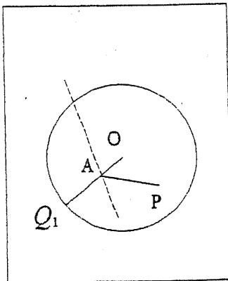
椭圓形  $\overline{Q_1A} = \overline{PA}$  且  $\overline{Q_1A} + \overline{AO} =$  圓之半徑
